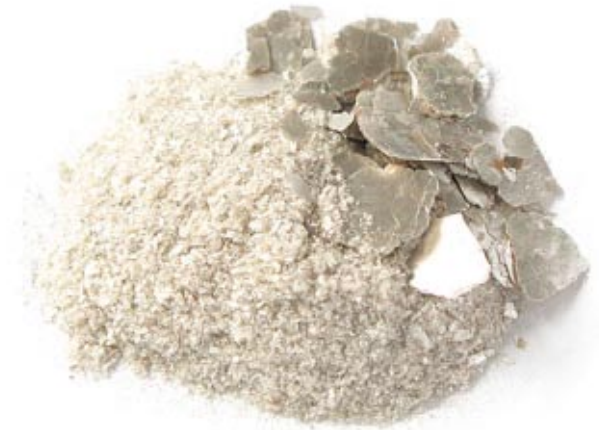
Erde und Mineralien - Muskovit (H 2 KAl 3 (SiO 4 ) 3 , D 50 = 20 μm
