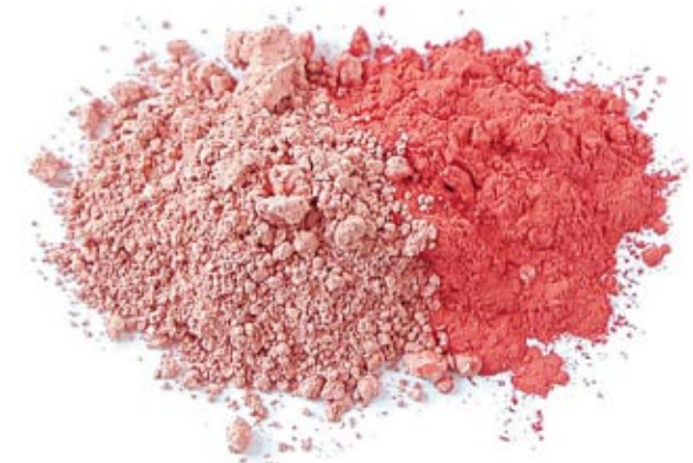
Pigmente - Zirkoneisenrosa (Zr/Si/Fe), D 50 = 2 μm
